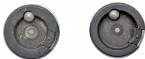
Вид спереди на стандартной и «магнумовски» затворы
