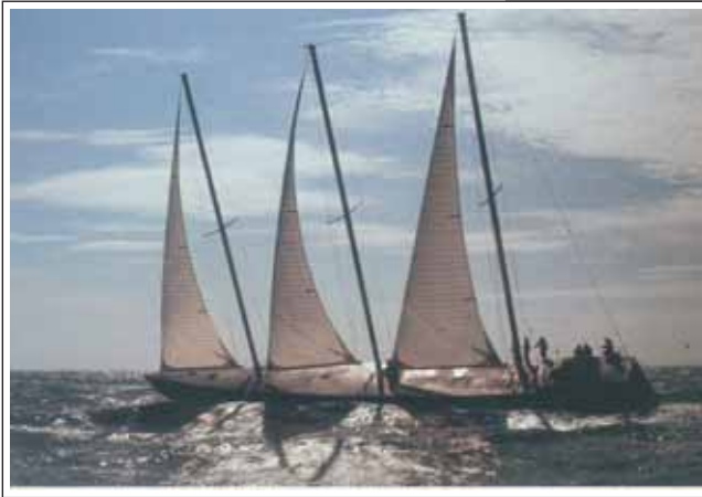
Основные чертежи и фото на ходу знаменитой гоночной суперяхты — трехмачтовой стаксельной шхуны «Vendredi, 13» («Вандредди, трез»), построенной по проекту Дика Картера для участия Жан-Ива Терлена в трансатлантической гонке одиночек ОСТАР-72
