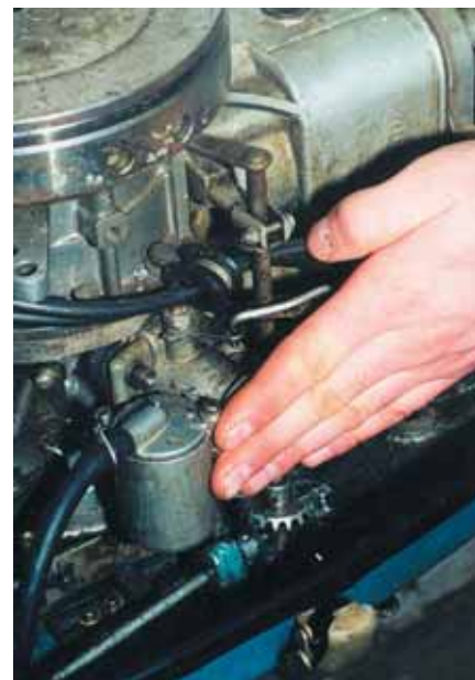
Так проверяют герметичность полостей картера
