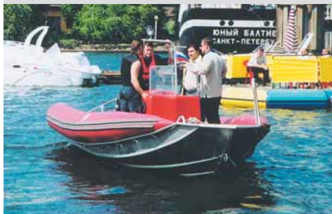
РИБ со сварным корпусом и незамкнутым в носу надувным баллоном фирмы “Спасатель”
