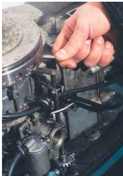
Определение степени износа посадочного места мадино на верхней крышке картера
