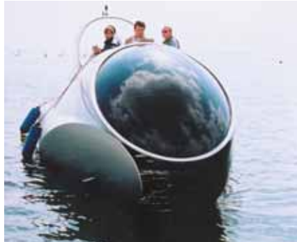
Этот необычный алюминиевый катамаран длиной 9.5 м оборудован двумя угловыми колонками с дизелями по 240 л.с.
