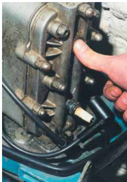
«Рабоче-крестьянская» методика проверки состояния поршня и поршневых колец
