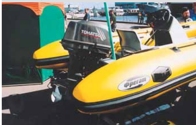
Новая полусферическая форма кормовых окончаний баллонов у “Фрегата”
