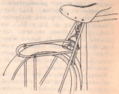
Рис. 9. Крепление багажника из дюралюминиевых трубок.
