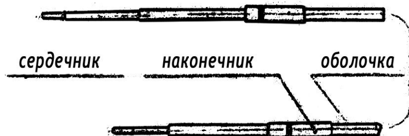
Рис 3 Гибкий привод
