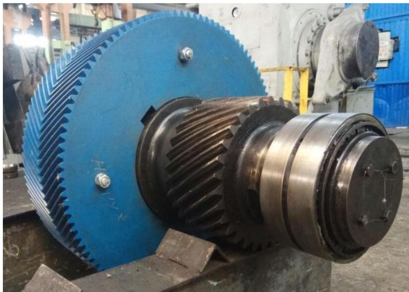
Рис.1. Шевронная шестерня редуктора диаметром 850 мм
